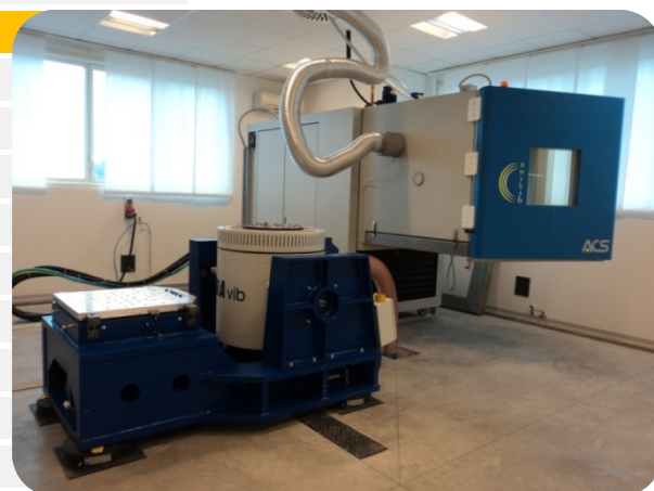
CAMERA CLIMATICA DA 1220 LITRI PER TEST COMBINATI DI VIBRAZIONE, TEMPERATURA, UMIDITA'.
